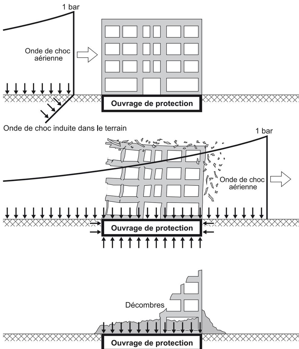
Figure 3 Actions sur un ouvrage de protection
