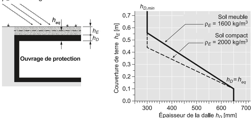
Figure 7 Épaisseur d'une dalle recouverte de terre
