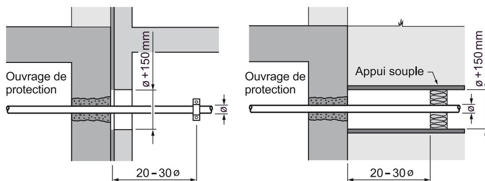
Figure 50 Introduction d'une conduite
