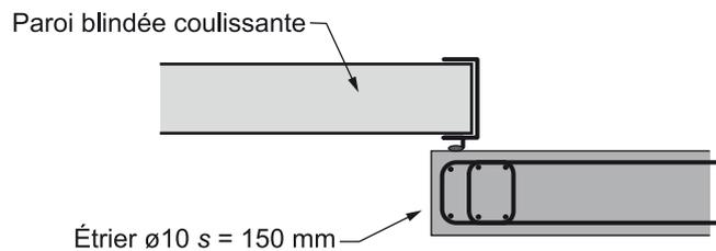
Figure 31 Mur d'appui d'une paroi blindée coulissante
