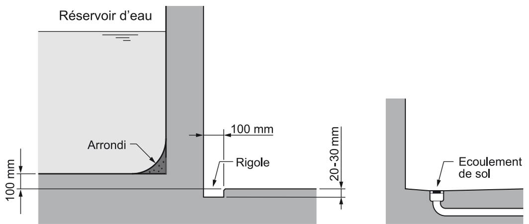
Figure 52 Détails de construction d'un réservoir d'eau
