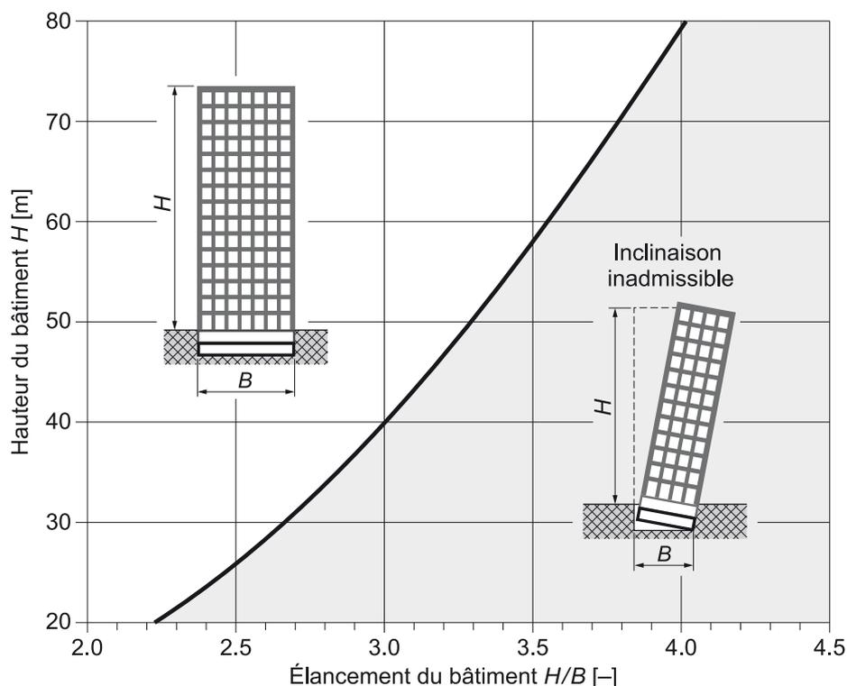
Figure 2 Risque d'atteindre une inclinaison inadmissible en fonction de la hauteur  $H$  et de l'élanement  $H/B$  du bâtiment
