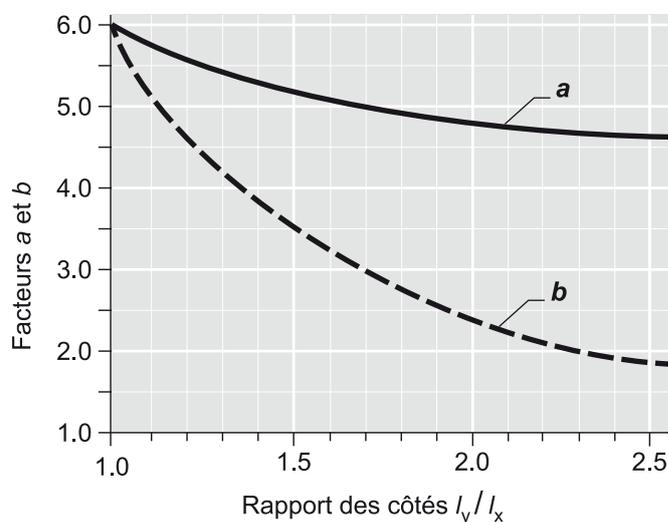
Figure 36 Facteurs de charge à la rupture a et b appliqués pour déterminer la charge ultime en fonction du rapport des côtés du radier  $l_y/l_x$
