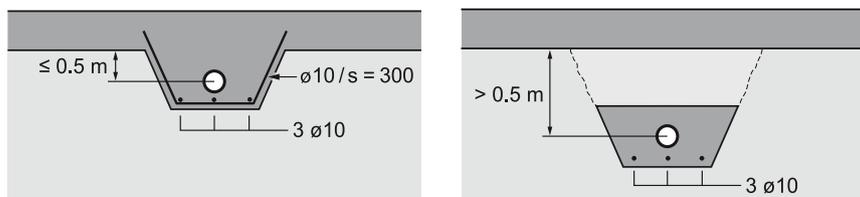
Figure 48 Passage d'une canalisation sous le radier
