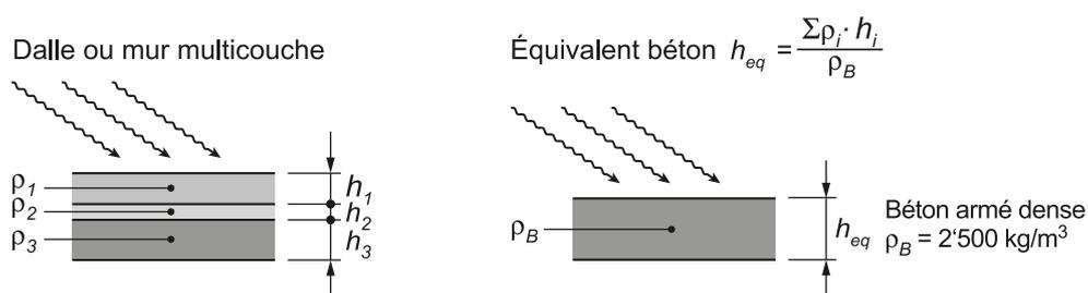
Figure 6 Équivalent béton
