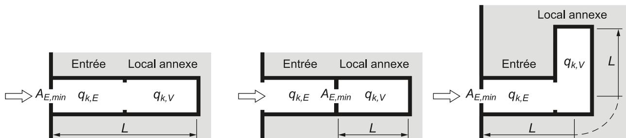
Figure 27 Configuration d'ouvrages d'entrée protégés comportant des corridors
