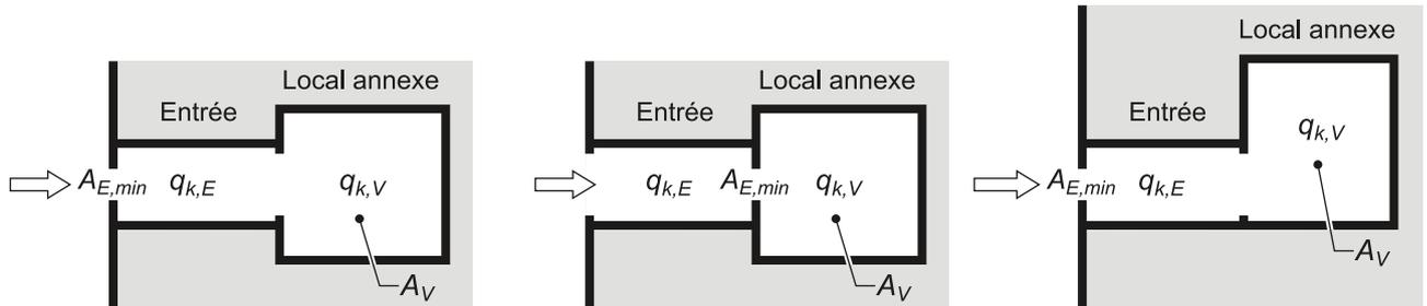
Figure 28 Configuration d'ouvrages d'entrée protégés pourvus d'un local annexe jouant le rôle de volume d'expansion
