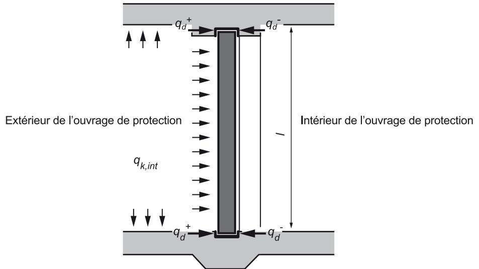
Figure 30 Réactions d'appui des parois blindées coulissantes
