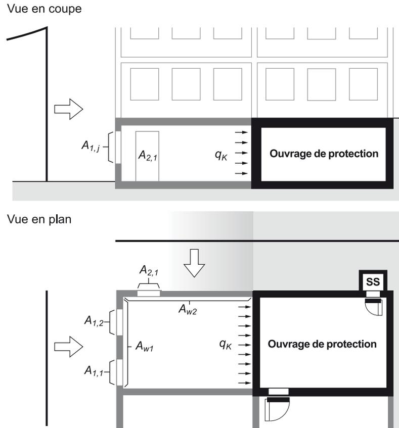
Figure 23 Exemple de détermination de l'action due à l'onde de choc aérienne qui s'exerce sur le mur extérieur d'un ouvrage de protection attenant à un local annexe non protégé
