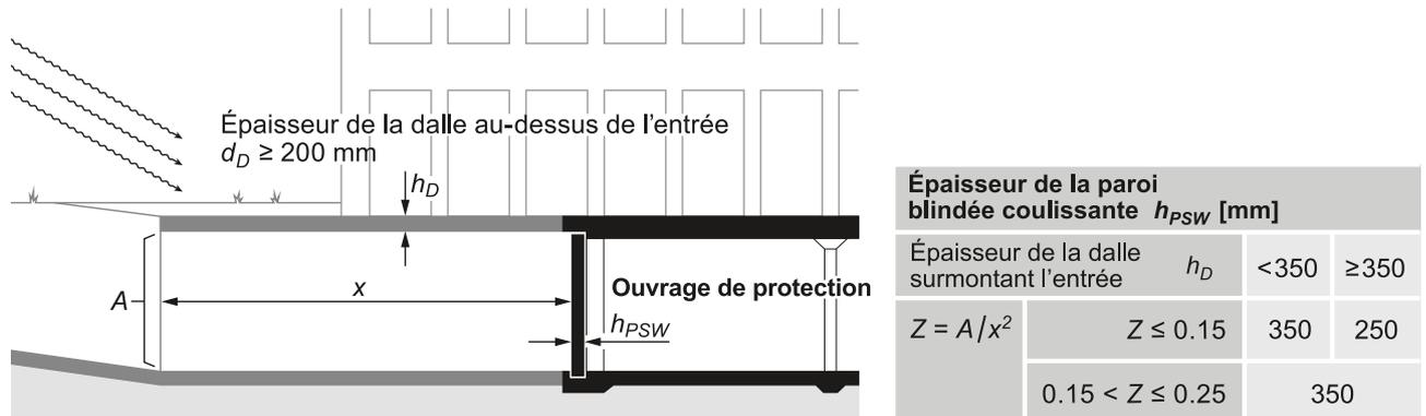
Figure 15 Épaisseur de la paroi blindée coulissante d'un abri aménagé dans un garage souterrain
