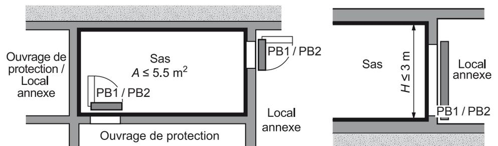
Figure 53 Éléments de construction d'un sas
