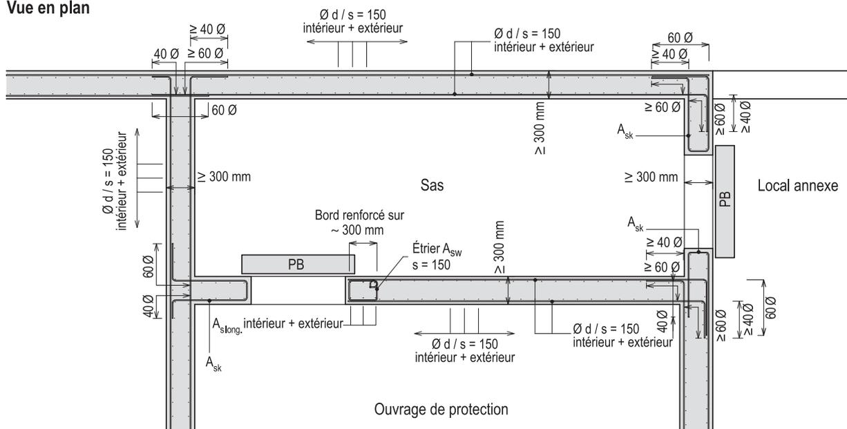
Figure 58 Armature d'un mur (étriers non représentés dans les murs)
