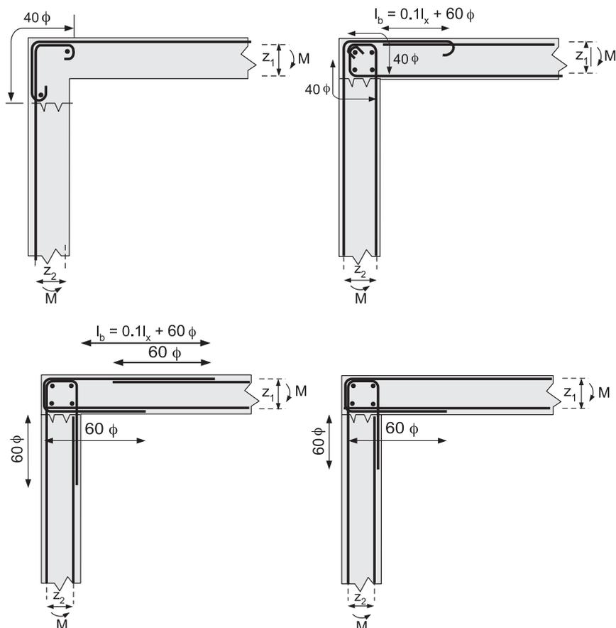
Figure 43 Armature d'un angle (seule l'armature de flexion est représentée)
